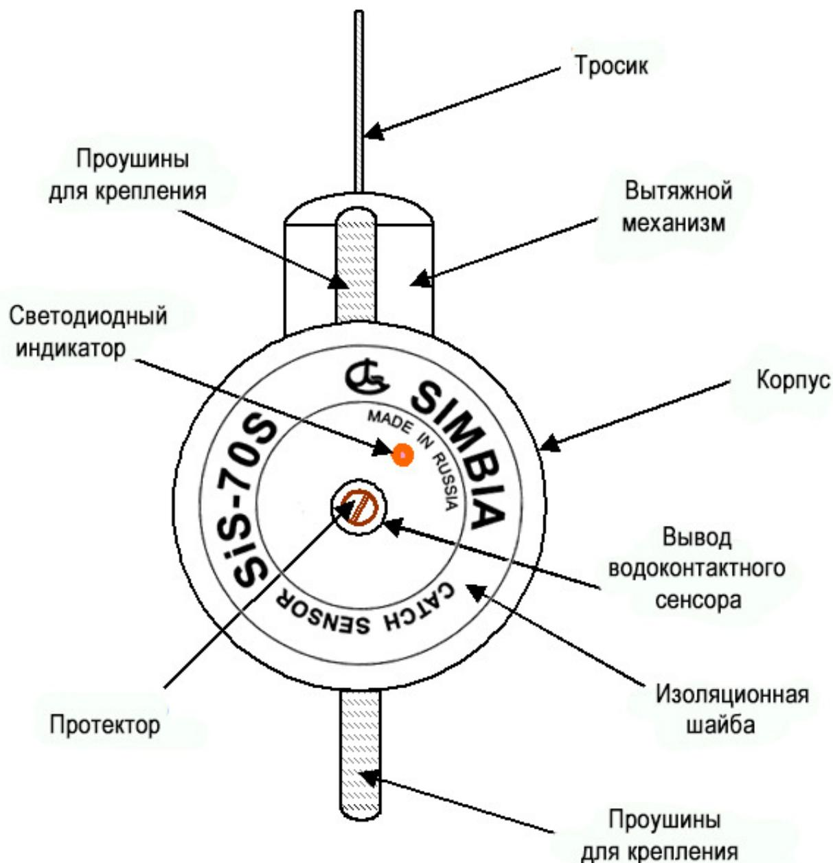
Вывод водоконтактного сенсора служит также для подключения зарядного устройства.
